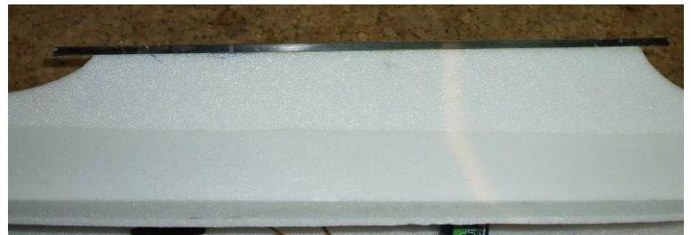
An der Unterseite der Tragflächenseite werden, damit die Position der Tragfläche auf dem Rumpf später nicht verrutscht, bei aufgelegtem Rumpf zwei Balsa-holzleisten (ca. 4x4 oder 5x5 mm) aufgeklebt. Um sicherzustellen, dass die Tragfläche nicht mit dem Rumpf verklebt, sollte hier ein Stück Frischhaltefolie zwischen Rumpf und Tragfläche gelegt werden, bis der Kleber getrocknet ist. Die Tragfläche sieht dann wie im Bild rechts aus
