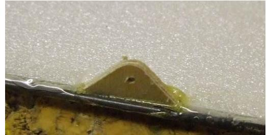
Am Rumpf wird der mittlere Verbindungspunkt der Fahrwerksbeine durch das Einkleben der Halterung erzeugt. Vor dem Anbringen müssen aber noch an dem senkrecht stehenden Seitenteil des Rumpfes die beiden Depron-Verstärkungen angebracht werden. Dies geschieht am besten durch flächiges Aufkleben mit Uhu Pur (nass in nass). Es hat sich als vorteilhaft erwiesen, beim
