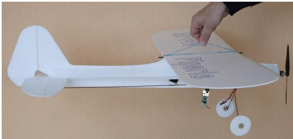
Im Folgenden werden dann die Servos mit Uhu-POR an den ermittelten Stellen angebracht und die Gestänge angeschlossen.
