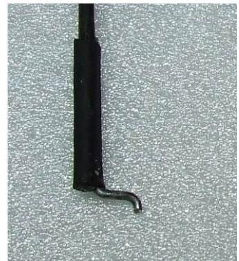
Nach dem Schrumpfen können nun die Enden an der Tragfläche befestigt werden.
