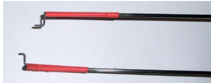
Bild 4: Obere Befestigungen der Fahrwerksstangen (werden in Sperrholz an Tragfläche eingehangen, siehe Bild 3)
