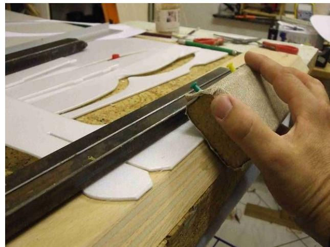
abgesägt wurde. Dadurch kann dann der Schleifklotz an diese 45 ° Abschrägung angelegt werden und die Kante wird sehr gerade.
