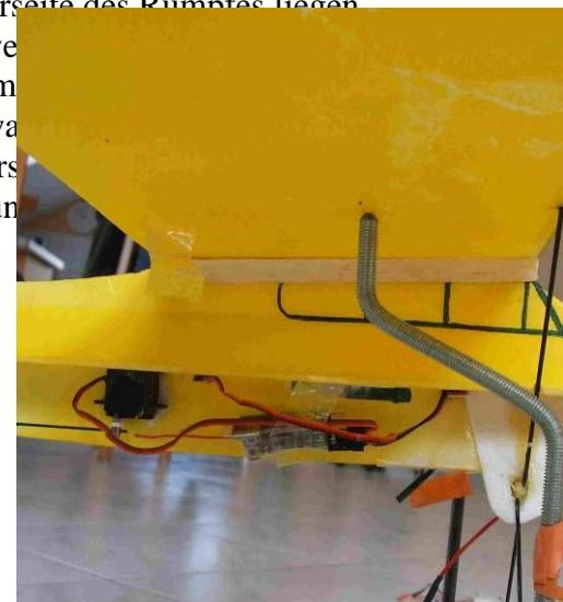
Im Folgenden werden dann die Servos mit Uhu-Por an die ermittelten Stellen angebracht und die Gestänge angeschlossen.
