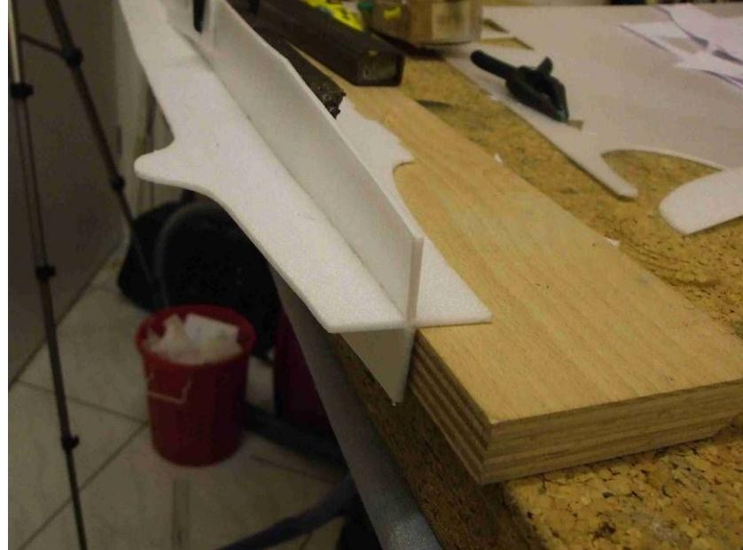
Als gutes Verfahren hat es sich erwiesen, das Höhenruder bereits vorher mit den Scharnieren und der Ruderfläche fertig zustellen (siehe Pkt. „Anbringung der Ruder“). Die Stoßstelle zwischen Höhenruder und den flachliegenden Rumpfteilen kann nun beidseitig mit Tesafilm verstärkt werden, so dass ein verschieben während des Trocknens ausgeschlossen ist.
